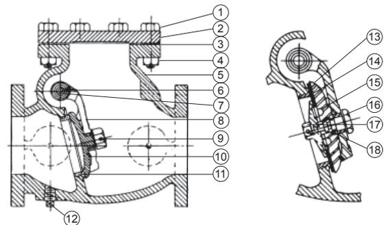
Nota: Generalmente si raccomanda che quando si usa la valvola di ritegno 126A di posizionarla ad almeno 5 diametri del tubo a valle di qualsiasi apperacchiatura che disturbi o ostruisca il flusso (valvole, pompa, gomito, riduttore, ecc.) Turbolenze nei pressi della valvola può provocare problemi di "chatter" con conseguente guasto prematuro della valvola di ritegno.
