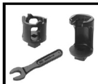
RICHTIG (Speziale Sprinklerschlüssel)
