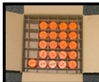
RICHTIG (Sprinkler durch Kappen geschützt)
