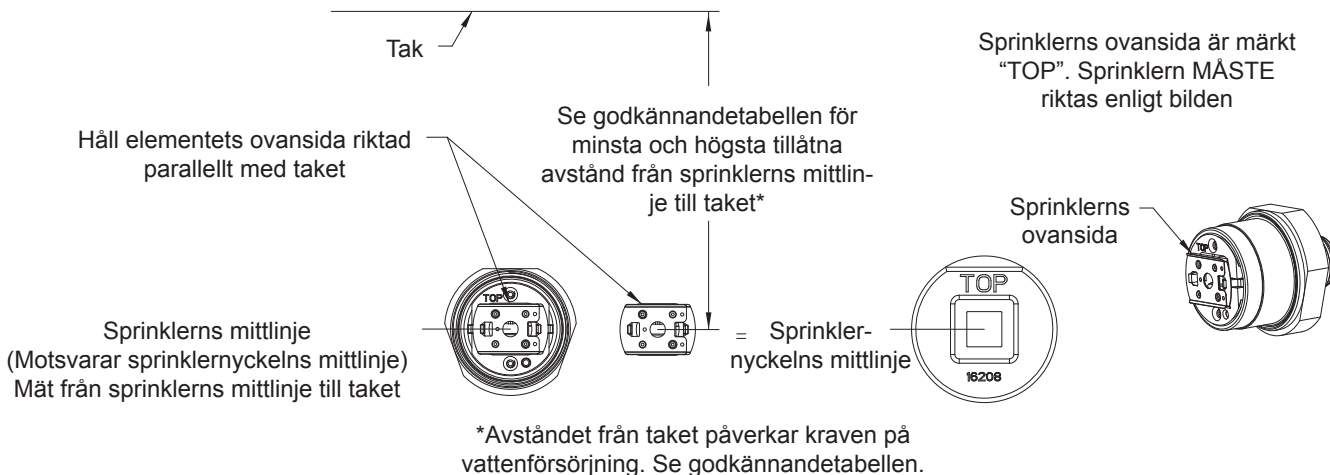
Bild 3: Sprinkler VK4800 korrekt riktning för spridarplatta
